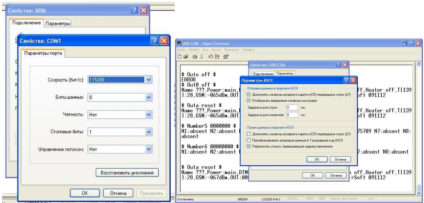
При включении (или после сброса) устройство выдаст на терминал перечень введенных номеров и статус устройства.
