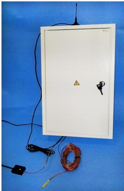
**Общий вид с внешними датчиками питания и температуры (вынос 7 метров) и внешней антенной (кабель 3 метра).** Устройство управляет включением/выключением шести/восьми каналов (с 0 по 5/7 220В /50Гц (по две линии 20А ... 63А, в зависимости от установленных контакторов), а также снимает показания внешних датчиков. Обмен информацией с владельцем осуществляется по сети GSM - звонки, DTMF команды, SMS, а также через USB интерфейс в режиме настройки и тестирования.
