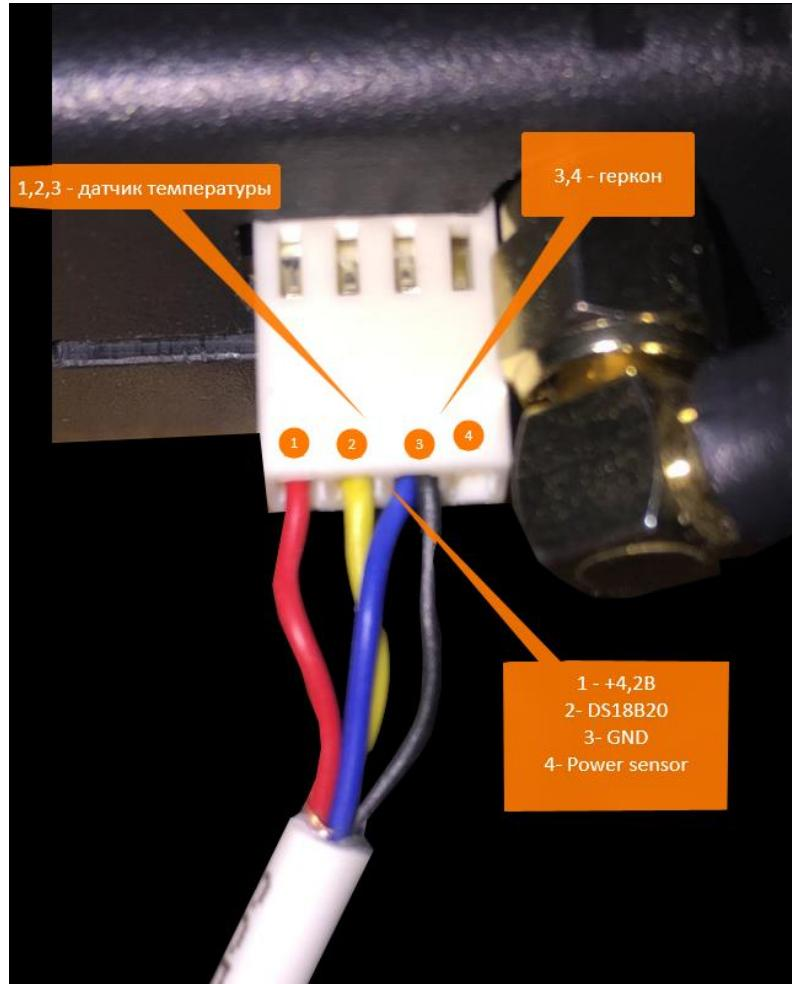
Под заказ все устройства оснащаются выносным датчиком питающей сети, шлейфом из выносных датчиков температуры (от 1 до 4) с диапазоном температур (-55°C...+125°C), микрофоном.
