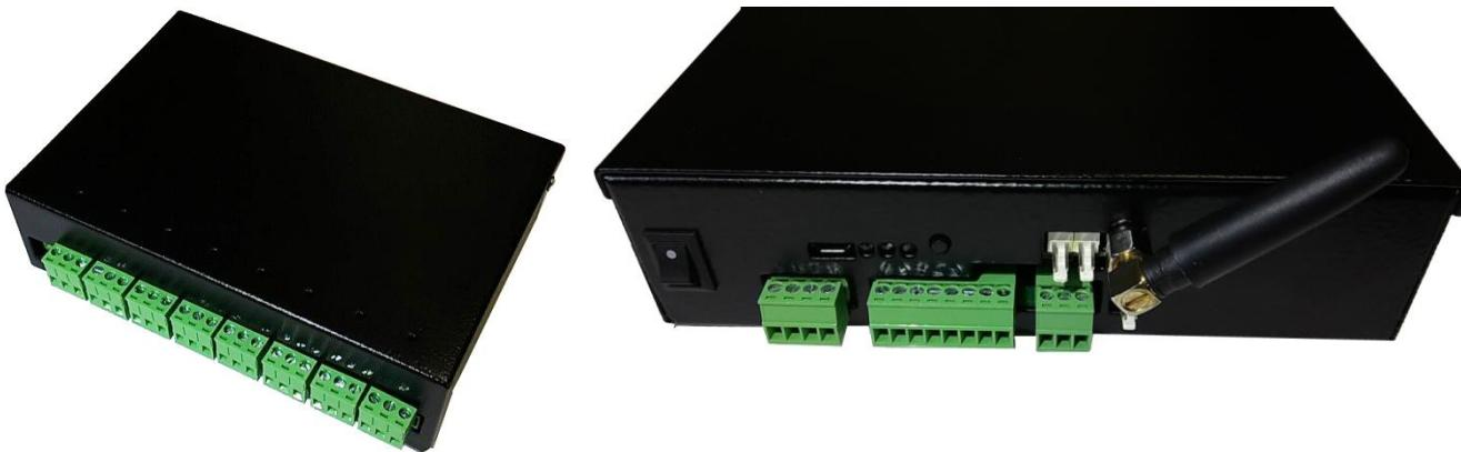
5) Трехканальный + сигнализация: вход – размыкаемый клеммник, выходы - три размыкаемых клеммника, на которых присутствует и нормально замкнутый выход реле (NC), и нормально разомкнутый (NO), входы сигнализации подключаются через шлейф непосредственно к плате управления (доступно поциальному заказу), также на боковой стороне корпуса через маломощный разъемный клеммник выведены четыре входа сигнализации, а также +12В и «Земля».
