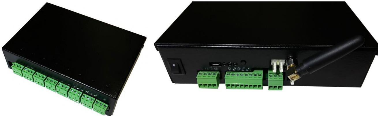
5) **Трехканальный + сигнализация**: вход – размыкаемый клеммник, выходы - три размыкаемых клеммника, на которых присутствует и нормально замкнутый выход реле (NC), и нормально разомкнутый (NO), входы сигнализации подключаются через шлейф непосредственно к плате управления (доступно по отдельному заказу), также на боковой стороне корпуса через маломощный разъемный клеммник выведены четыре входа сигнализации, а также +12В и «Земля».
